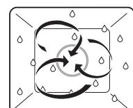
L'air de l'espace de cuisson est chauffé par le corps de chauffe situé derrière la paroi arrière de l'espace de cuisson et circule de façon homogène. Un minimum d'humidité qui se dégage des aliments est évacué de l'espace de cuisson. L'humidité de l'aliment à cuire est conservée.
