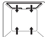
Le chauffage est effectué par les corps de chauffe supérieur et inférieur.
