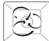
L'air de l'espace de cuisson est chauffé par le corps de chauffe situé derrière la paroi arrière de l'espace de cuisson et circule de façon homogène. L'ouverture de la porte commandée en fonction du temps permet de largement dissiper l'humidité sortant de l'aliment à cuire à intervalles réguliers. L'aliment à cuire se dessèche lentement.
