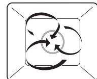
L'air de l'espace de cuisson est chauffé par le corps de chauffe situé derrière la paroi arrière de l'espace de cuisson et circule de façon homogène.
