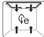
Cette application est particulièrement économique en énergie. Le chauffage est effectué par les corps de chauffe supérieur et inférieur. L'humidité qui se dégage des aliments est conservée dans l'espace de cuisson. L'aliment à cuire sèche moins.
