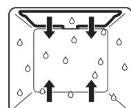
Le chauffage est effectué par les corps de chauffe supérieur et inférieur. Un minimum d'humidité qui se dégage des aliments est évacué de l'espace de cuisson. L'humidité de l'aliment à cuire est conservée.
