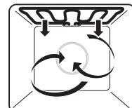
Le chauffage est effectué par le corps de chauffe du gril. L'air de l'espace de cuisson est soufflé uniformément par le ventilateur d'air chaud.
