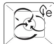
Cette application est particulièrement économique en énergie. L'air de l'espace de cuisson est chauffé par le corps de chauffe situé derrière la paroi arrière de l'espace de cuisson et circule de façon homogène. L'humidité qui se dégage des aliments est conservée dans l'espace de cuisson. L'aliment à cuire sèche moins.
